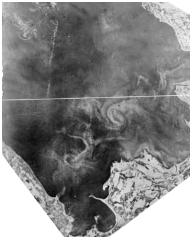
Проявление гидродинамических явлений на поверхности озера по спутниковым данным Спутниковый снимок Ладожского озера 10 IX 1979 г. (разрешение 70 м, видимый и ИК диап.)
